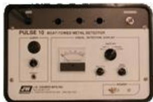
**В стандартную комплектацию прибора Pulse 10 входит:** поисковая катушка размером 18 дюймов в диаметре (около 45,7 см), кабель 45,72 м, буксируемый снаряд, блок управления. На блоке управления содержится регулятор чувствительности, а также звуковой сигнализатор и индикатор уровня сигнала, которые оповещают об обнаружении металлических объектов.
