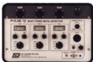
**В стандартную комплектацию прибора Pulse 12 входит:** поисковая катушка размером 24x36 дюймов (около 61x91,4 см), кабель 45,7 м, буксируемый снаряд, блок управления. На блоке управления расположены 3 комплекта регуляторов, которые позволяют подключать к прибору до 3 катушек одновременно, а также индикатор уровня сигнала и звуковой сигнализатор, которые оповещают об обнаружении металлических объектов. С каждой катушки производится отдельное считывание данных, получаемых при поиске.
