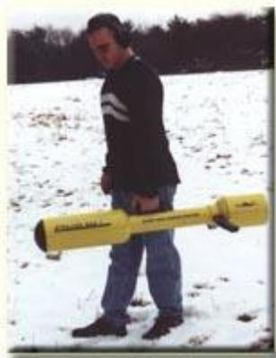
Особенностью **Diver Mag-1** является подавляющий шум трёхосный датчик, который позволяет держать магнитометр в любом положении без ущерба для чувствительности и стабильности считывания.
