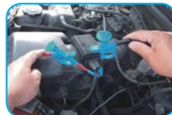
Connecting cable 【Red(+), Black(-)】 one meter long cables.
