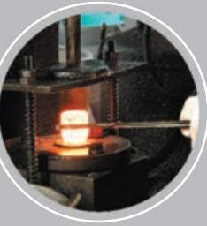
Нагревание для передачи формы и улучшения пластичности
