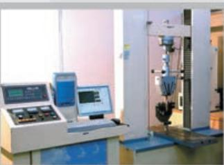
Испытательный стенд прилагает усилие специально в месте соединения элементов продукции в соответствии со стандартом DIN
