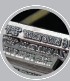
Штамповка размеров, материала и изготовителя
