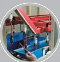
Тестирует диэлектрические инструменты под напряжением 1000 вольт
