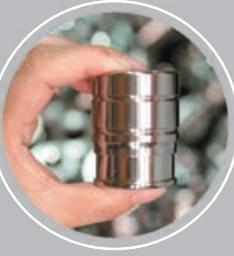
Придание внешнего диаметра головке и создание проточек
