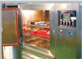
Создаёт резкий перепад температур от -20 до +70°C для анализа состояния детали с последующим выводами о ее качестве
