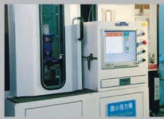
Тестирует продукцию с небольшим крутящим моментом, такую как вставки, на износостойкость
