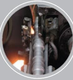
Удаляется оксидный слой и обеспечивается округлость головки для дальнейшего высокоточного процесса обработки
