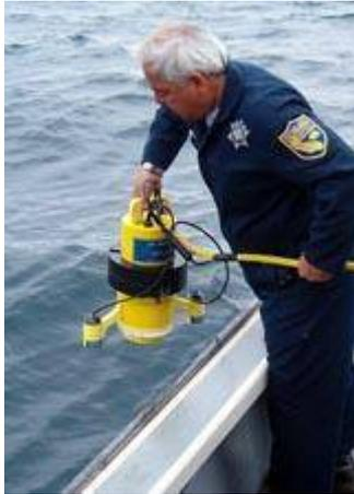
**Дополнения к стандартной комплектации включают:** кабель длиной до 305 м (1000 футов), цветная или черно-белая камера, функционирующая при низкой освещенности; черно-белый или цветной монитор с видеомagneтoфоном и монитором, камеры для европейского рынка (видеостандарт PAL), дополнительные лампочки, вводы напряжения 12 В постоянного тока или 220 В переменного тока; корпуса прибора, позволяющие работать с прибором на глубине 152 м и 305 м.
