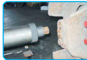
3. Take off anchor pin. 取下來令片插銷。
